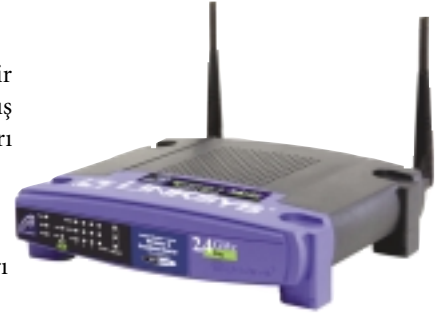
Linksys WRT54G: Güncelleme sonrasında her iki anten de ayrı ayrı çalışıyor ve veri aktarım oranını artırıyor.
