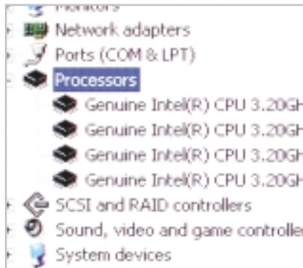
4 işlemci aynı pakette: Pentium Extreme Edition işlemcisinde ikisi fiziksel, ikisi mantıksal, dört adet işlemci bulunuyor.
