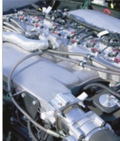
Temiz motor: Aracın motoru klasik içten yanmalı, enjeksiyonlu motorları andırıyor. Ama hidrojen yakıyor.
