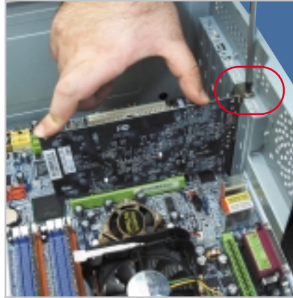
Ekran kartı montajı 1: Kartı yuvasına oturtuktan sonra kasaya tornavida yardımıyla vidalayın.
