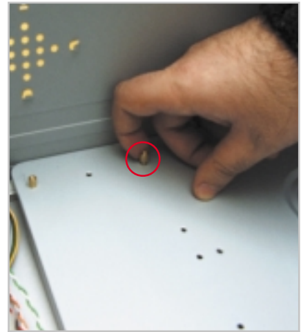
Anakart montajı 1: Anakartı kasaya yerleştirmeden önce kasa üzerinde uygun yerlerde vida ve spacer'ları takın.
