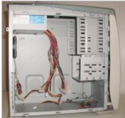
Kablo ve konektörler: Güç kaynağından gelen voltaj büyüklükleri, kablolar yardımıyla bileşenlere aktarılır.
