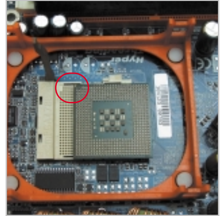
CPU montajı 1: P4 işlemcilerde bir köşede pinler eksik. İşlemciyi yuvasına yerleştirirken bu köşeye dikkat edin.
