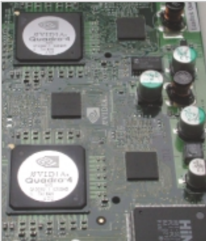
Bir elin nesisi, iki elin sesi: Bazı profesyonel ekran kartları tek işlemciyle yetinmez ve iki işlemcinin hesaplama gücünü kullanır.
