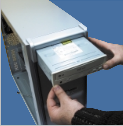
CD/DVD sürücü montajı 2: Şimdi sürücüyü yuvasına itebilir ve kasaya vidalayabilirsiniz.
