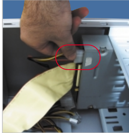
CD/DVD sürücü montajı 3: Son olarak güç kablosunu bağlayın, artık sürücünüz çalışmaya hazır.
