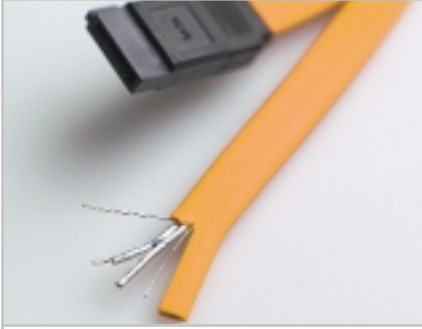
Veri kanalizasyonu: Başarılı yalıtma ve diferansiyel sinyaller sayesinde veriler kablodan saniyede 1,5 GHz hızla akıyor.
