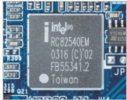
Shuttle AN50R: Athlon 64 anakartında bir Intel yongası GBit LAN bağlantısı sağlıyor.
