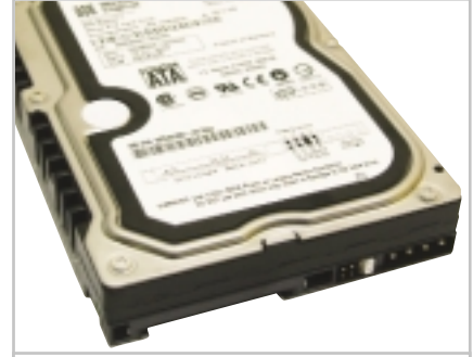
Seri ATA diskler: Piyasaya ilk çıkan Seri ATA diskler IDE öncülerinden çok daha hızlı değiller.
