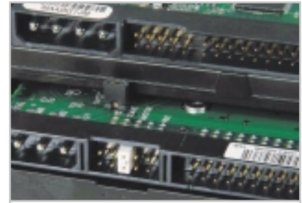
İkili oyun: Aynı kabloya iki disk bağlarken jumper ayarlarına dikkat.
