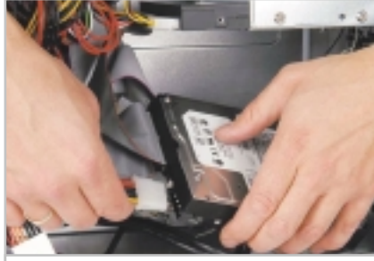
Montaj: IDE kablosunun kırmızı renkli tarafı güç kablosunun yanında olmalı.
