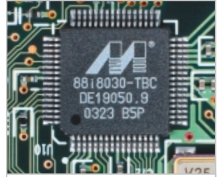
Köprü: ATA to SATA bridge yongası yeni sabit disklerdeki tek gerçek seri yapı taşı olarak karşımıza çıkıyor.
