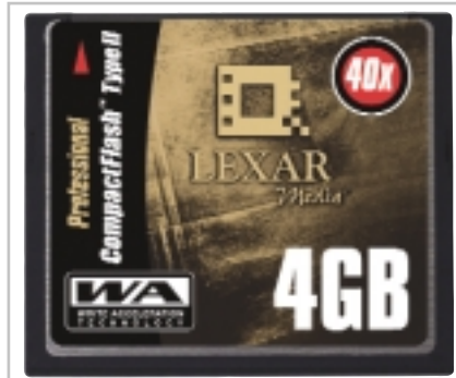
Compact Flash: CF bellek kartları, 4 GB'a ulaşan kapasiteleri ile günümüzde en çok tercih edilen alternatiflerden biri.
