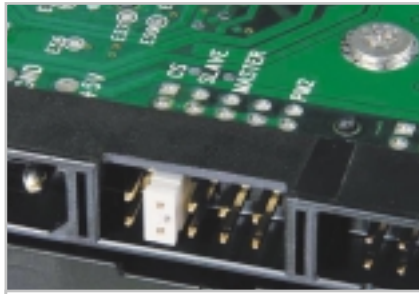
Jumper sorunu: Jumper ayarları maalesef üreticiden üreticiye değişiyor.
